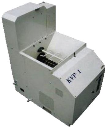
本装置へ切削油が付着したままの切り屑類を投入することにより、ほとんどの金属切粉を1/10~1/40に圧縮・固定化します。また、付着した切削油を分離回収し再利用することもできます。省コスト・簡単操作・安心の静音設計、7kg仕様となっており、チップコンベアと直結、24H稼働も可能です。
